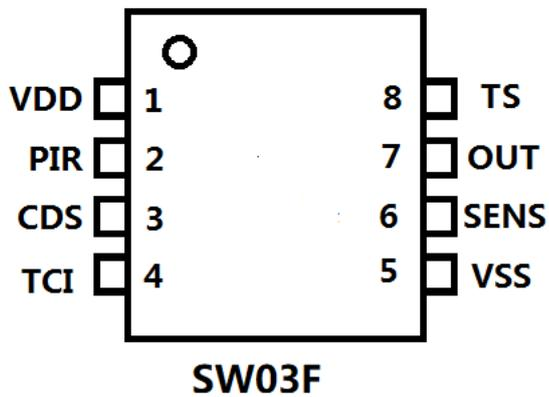
人体热释红外线感应控制 IC (延时时间可调、光敏可调)
